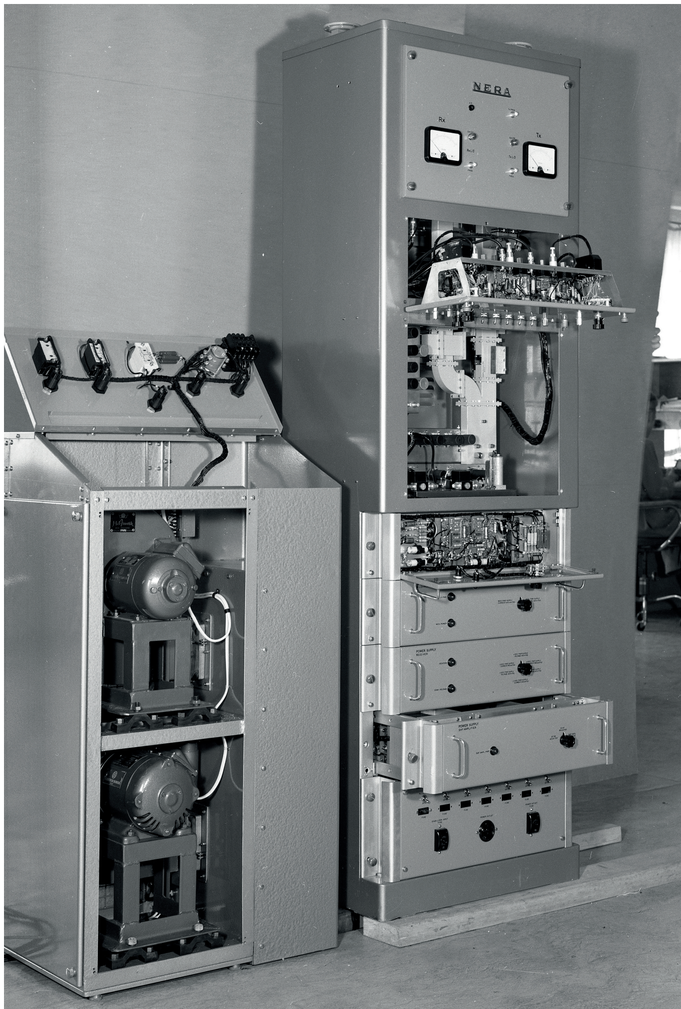
NL40 som ble utviklet i tidsrommet 1959-60 og installert mellom Oslo og Bergen klart for bruk ved åpningen av fjernsynet i august 1960. Foto: NERA Museum
