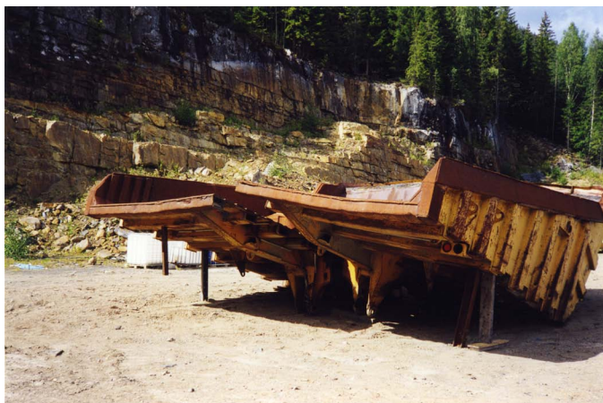
Dumperkassa var delt i to for transporten, og ble sveiset sammen igjen da trucken skulle monteres sammen igjen. (Foto fra Norsk vegmuseum)
