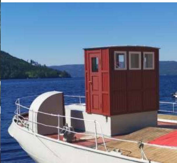
Juni 2020. Rekonstruert styrhus, casing og dekk malt. Utenpåliggende listverk, dører og vinduer montert.
