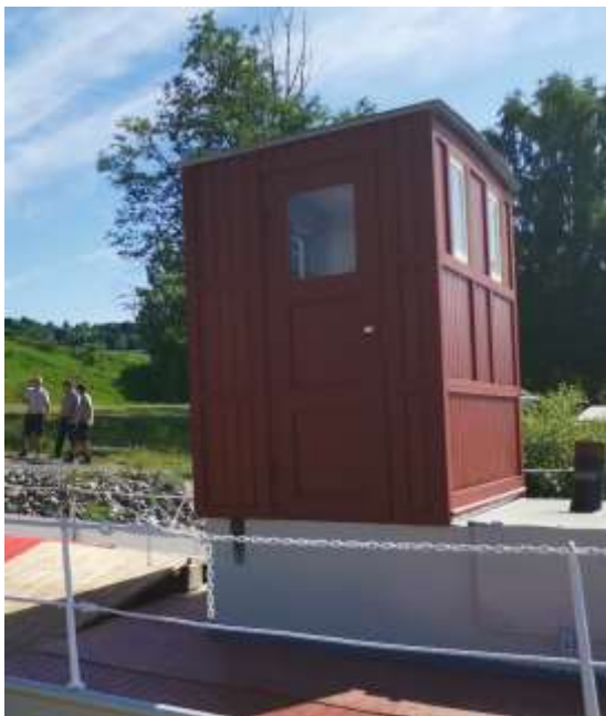
Juni 2020. Rekonstruert styrhus, casing og dekk malt. Utenpåliggende listverk, dører og vinduer montert.
