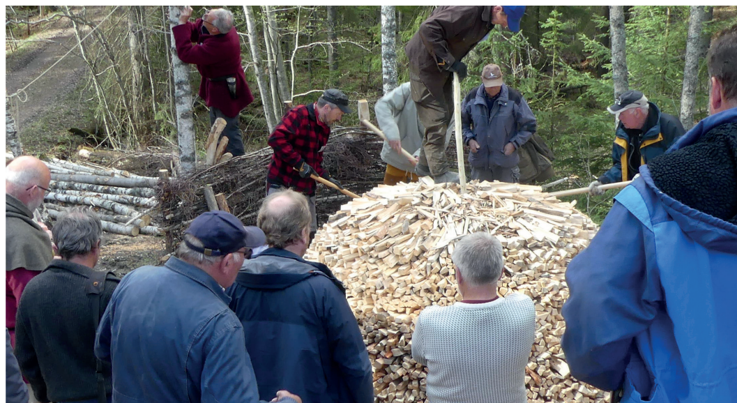
Haaraade vikingskipsforening fra Ask på Ringerike har her bygget en tjæremile. Foto: Ole Jørgen Schreiner
