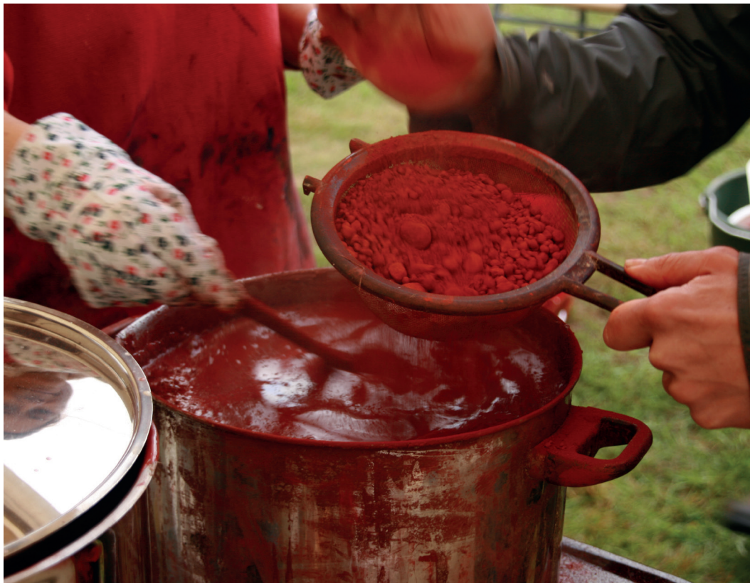
Komposisjonsmaling kokes i en gryte og røde pigmenter tilsettes gjennom en sikt. Foto: Fortidsminneforeningen/Ola Fjeldheim
