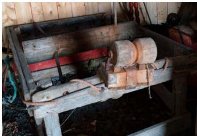
Dette er nærmest en kurositet, nemlig et håndspill for berging av varpstreng og stein. Strengen ble snurret opp på tresylindren i bakkant og styrt gjennom rullene foran. Sylindren var utstyrt med spaker for lettere «haling». Foto Edgar Østreim.
