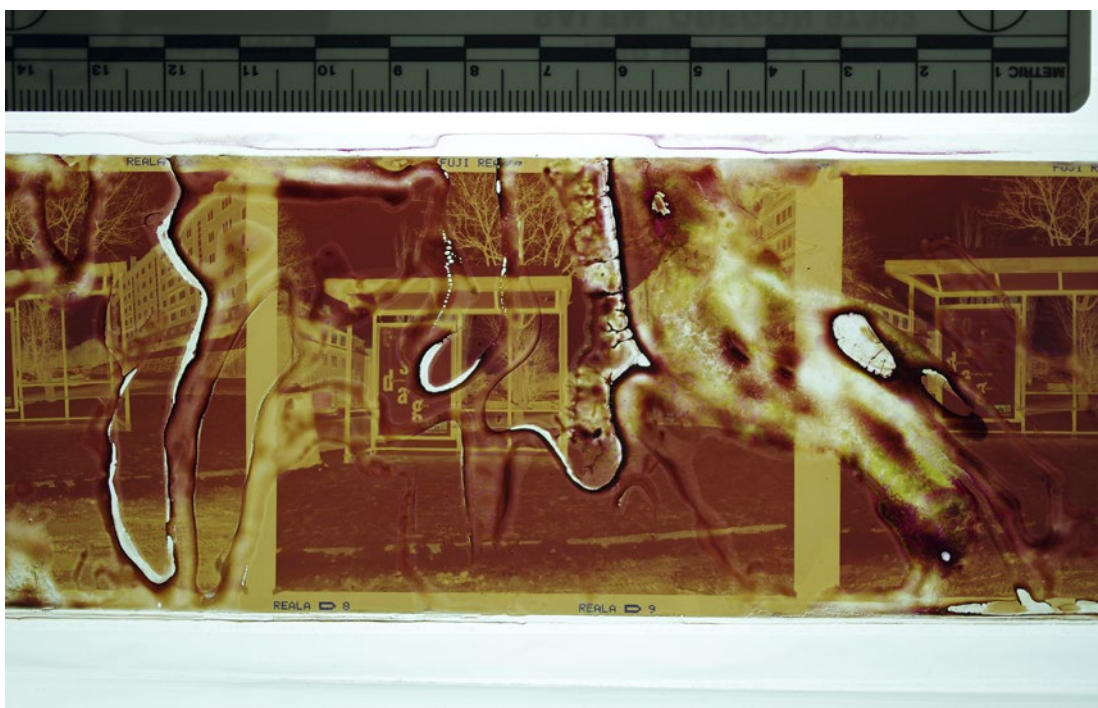
ILL. 20 Fuktskadet fargenegativ – totalskadet eller ikke?
