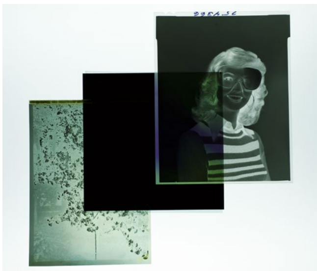
ILL. 18 Polarisasjonstesten viser umiddelbart hva som er en polyesterbase og hva som ikke er det.
