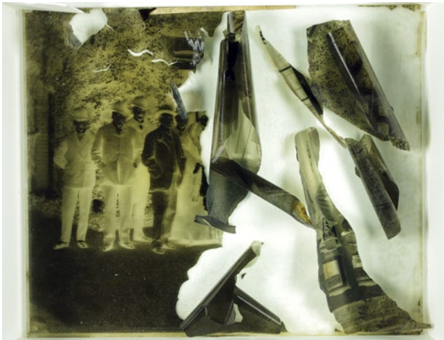
ILL. 12 Gelatinemulsjonen løsner fra glasset på et tørrplatenegativ.
