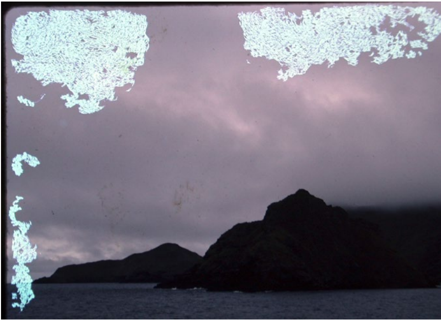
ILL. 05 Spiseskader etter insekter på et farge diapositiv.
