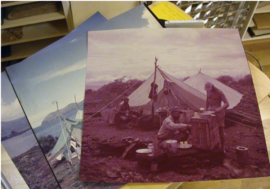
ILL. 09 Fargeskift på et fargefotopapir (engelsk: chromogenic color paper).
