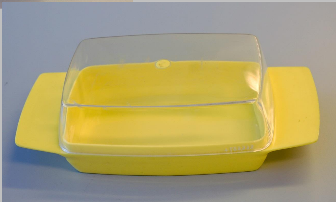
Slagtålig styrenplast, sampolymer med butadien, 70% etanol
