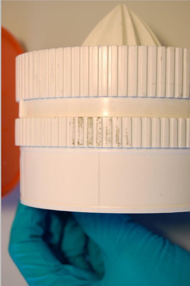
Propenplast med adhesivrest, rengöres med 70% etanol, efterrensning
