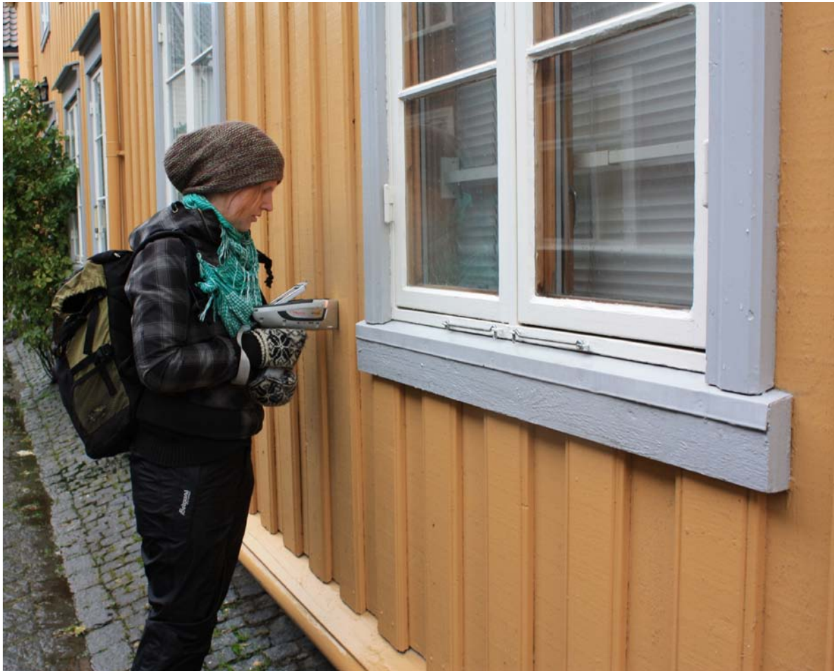
Figur 4 Måling av grunnstoffer på malt flate. Flaten ble bestrålt i 60 sekunder i hvert målepunkt.
