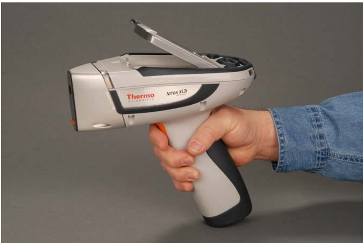
Figur 3. XRF-instrumentet som ble benyttet i undersøkelsen.
