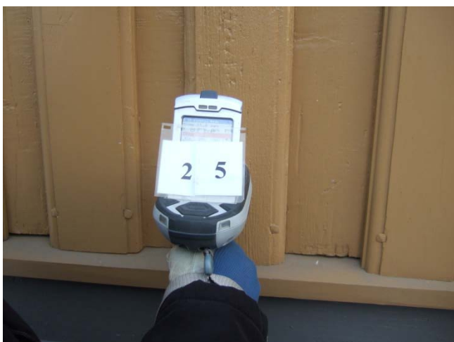
Figur 11 Målepunkt nr 24 er et nytt panelbord, mens målepunkt 25 er et gammel renskrap panelbord.
