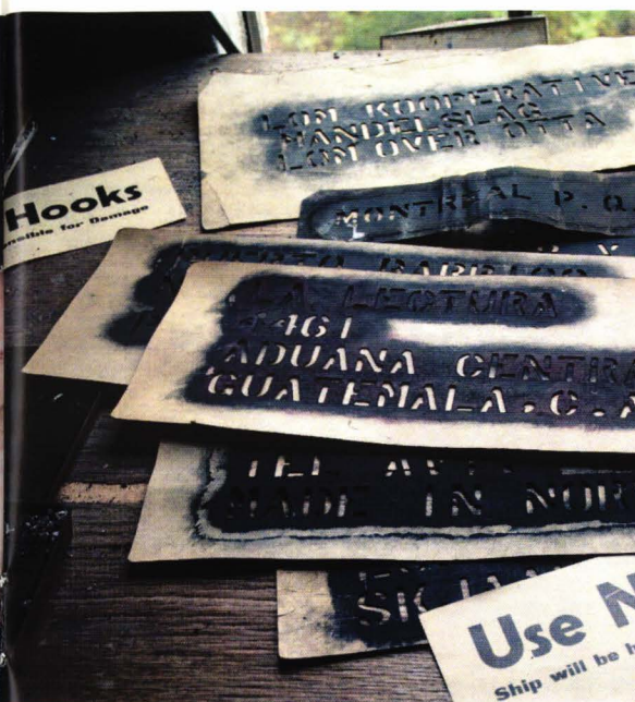
KLEVFOS-PAPIRET ble solgt på et stort marked. Bildet viser sjablonger for merking av pakningene.
