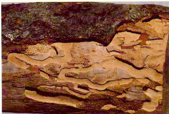
68. Skada på lövträ orsakad av föränderlig barkbock.
