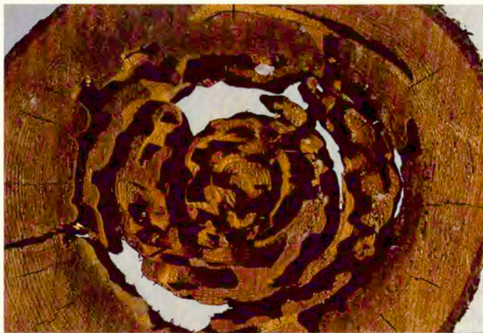
93. Skador orsakade av hästmyra. Myran äter inte träet, utan bygger "bara" bo i det.
