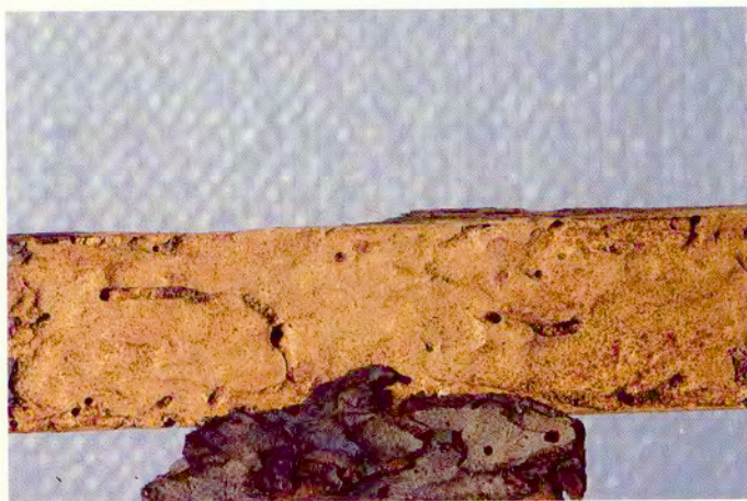
47. De grunda larvgångarna av mjuk trägnagare mellan bark och splint.
