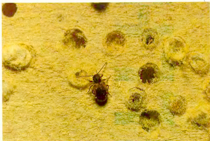
55. Australisk tjuvbagge, Ptinus tectus . Skador av puppgångar.
