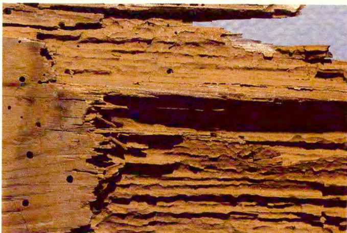
43. Larvgångar av envis trägnagare i rötskadat virke.
