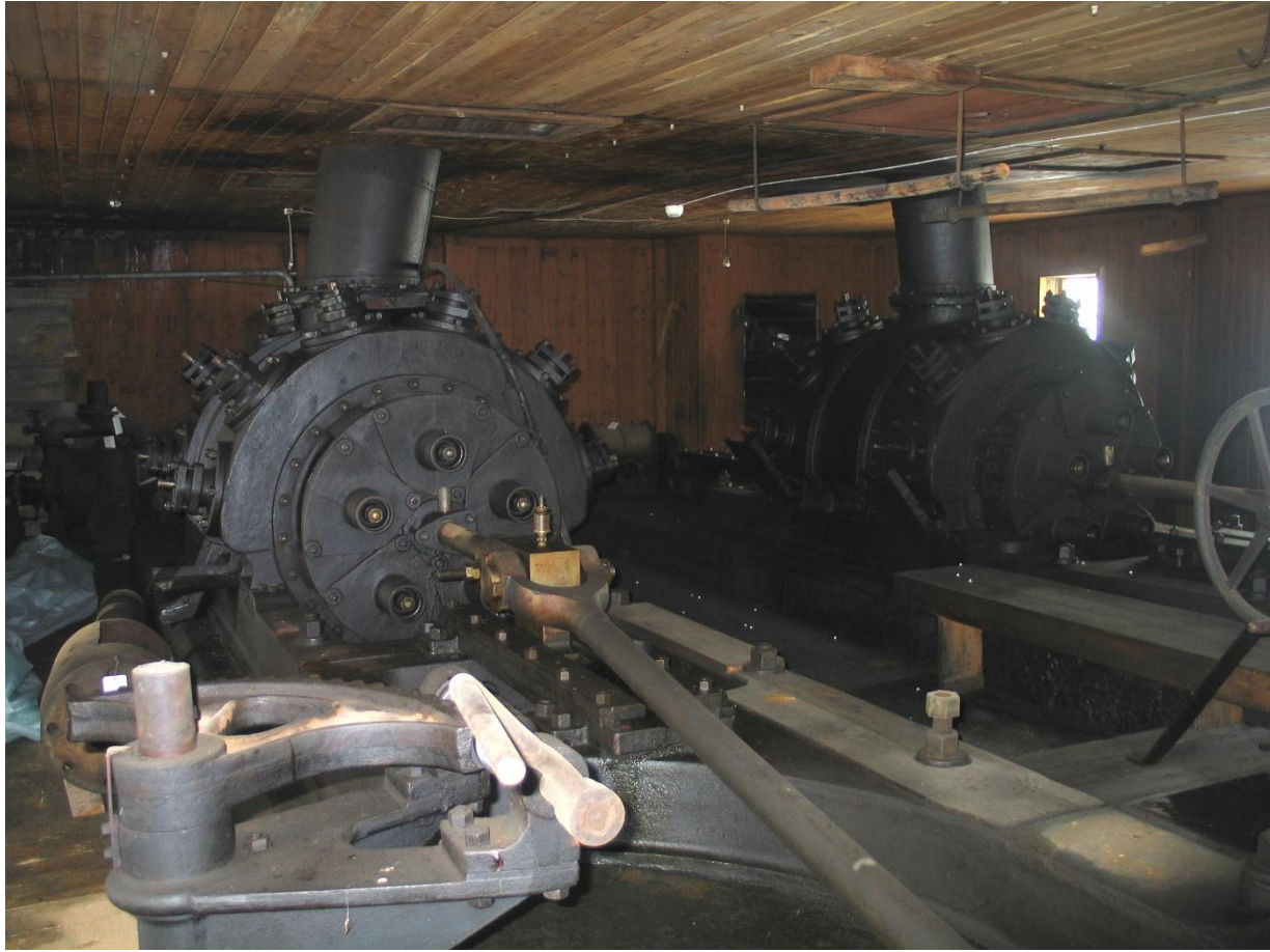
Dobbeltvirkende sylindermaskin Fra Nidelvens fabrikk T.M.V
