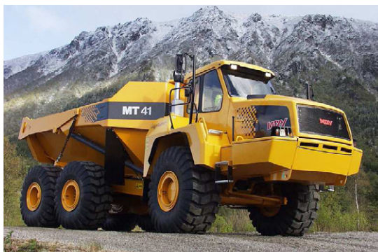
Grunnkonseptet med seks hjul og sekshjulsdrift ble beholdt av Moxy, her modellen MT41 fra 2003, (Foto fra Moxy)
