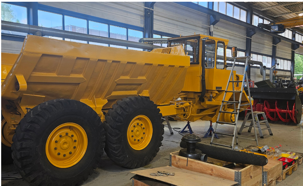
Bak førerhuset måtte det nytt stål til. Dumperen har en Scania D58-motor med 202 hk og vekta er 12.300 kg. (Foto: Magne Hagberg)
