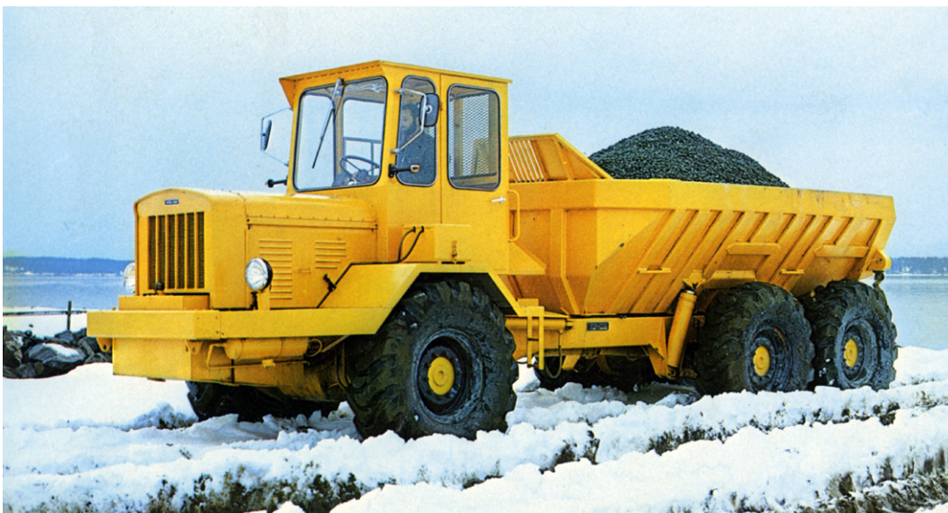
Viking D15 med 6-hjulsdrift viste seg meget effektiv i bløtt og vanskelig terreng, og svarte til forventningene. (Leverandørfoto fra Øveraasen)
