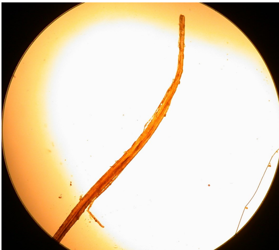
Fiberanalys vantens slityta. Växtfiber.
