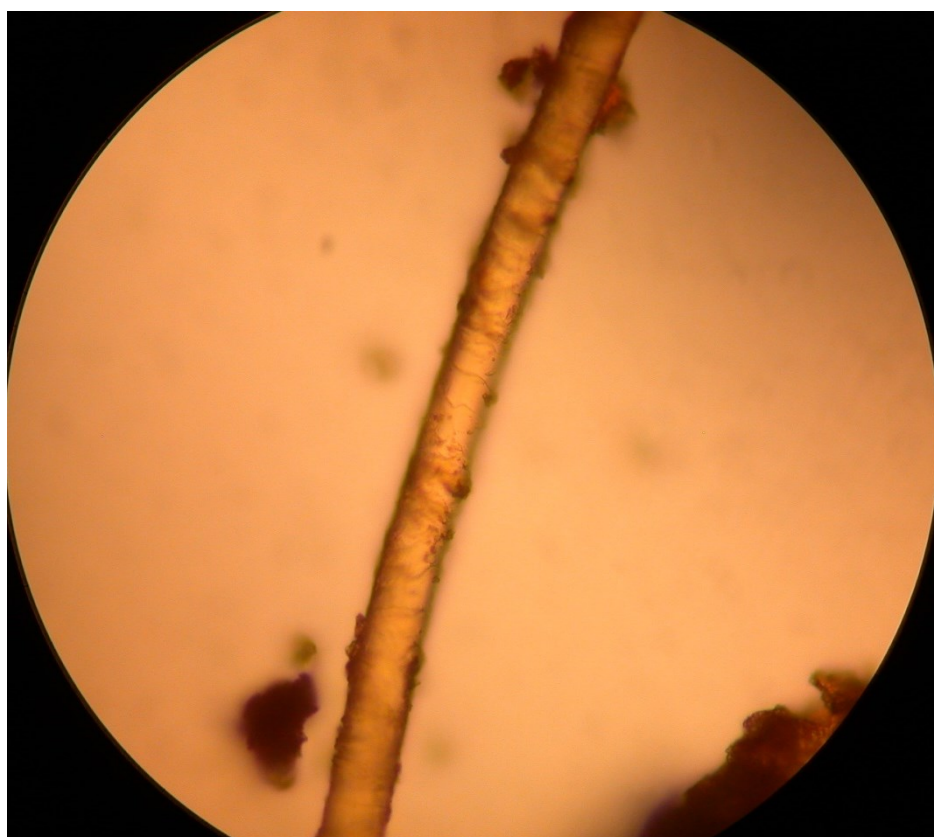
Fiberanalys vanten, ytterligare förstörad. Ull.
